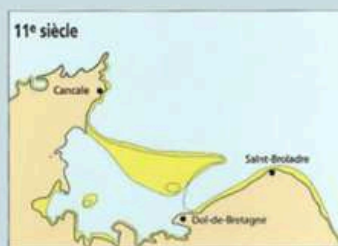
Construction de la première digue, de pointe de Château Richoux à Chermois. Assèchement des terres entre les deux bancs de sable.
