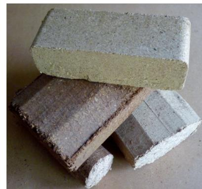
Elle doit être utilisée avec précaution ! Une bûche densifiée a un pouvoir calorifique supérieur à une bûche traditionnelle. Si l'on surcharge, il y a des risques d'endommager l'appareil ! Lui conseiller de tester avec une seule, puis 2 bûches.
