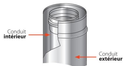
Le tube concentrique est composé de deux conduits imbriqués l'un dans l'autre : le conduit à l'intérieur sert à évacuer les fumées, tandis que de l'air est amené par le conduit extérieur. Il peut s'utiliser en pose classique (la lame d'air extérieure sert alors d'isolant) ou en circuit de combustion étanche (amenée d'air directe). Lorsque le positionnement idéal du poêle amène à installer un conduit devant débou-
