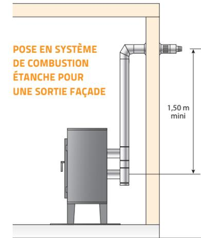
POSE EN SYSTÈME DE COMBUSTION ÉTANCHE POUR UNE SORTIE FAÇADE
